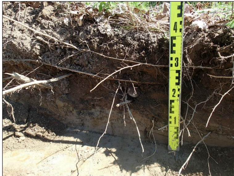
Koeojan 1 kerrosjärjestys pintamaasta lukien: 0-30 cm löydötön peltomulta ja 30-40 cm harmaa hiesu, jossa rautasaostumia.
