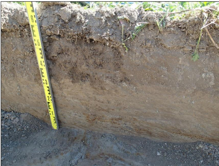
Koejojan 2 vallitsevana esiintynyttä maalajia kohdassa N 7051832 E 508549. Pintamaasta lukien: 0-25 cm kyntökerros ja 25-60 cm luontaisesti hiesuun sekoittunut savi, jossa rautasaostumia.
